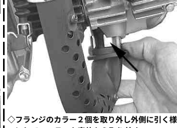
◇インレットパイプをシリンダーヘッドにとめているボルト2本を取り外しインレットパイプ、キャブレター、エアクリーナーを取り外す。
