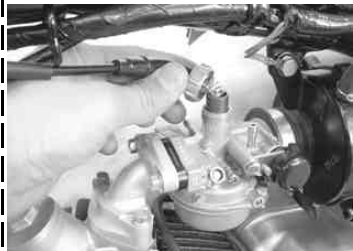
◇キャブレターのトップキャップを外し、スロットルバルブをキャブレターから抜き取る。
