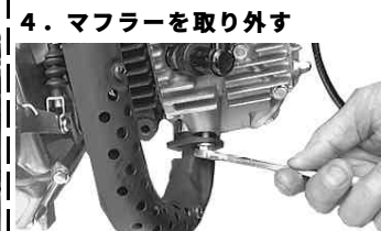
◇EXパイプ部のナット2個を取り外す。
