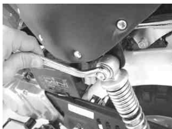
◇リアショックのナット2個をゆるめる。
