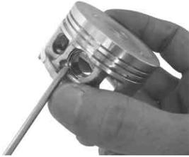
ピストンの左側に付属のピストンピンサークリップをサークリップ溝にキッチリはめ込む。この時、サークリップの合い口は切り欠き部を避けて取り付けれる。
