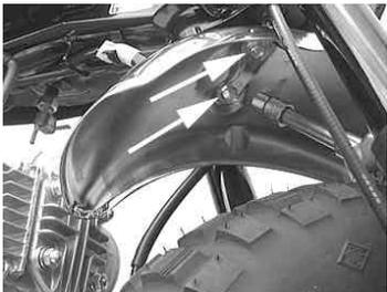
フロントフェンダー裏側の六角ボルト2本を締め付けて取り付ける。
