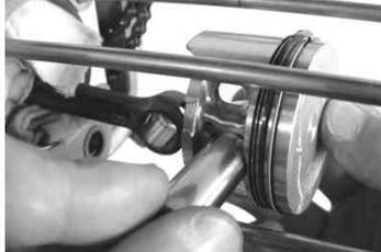
ピストンに三分の一程度ピストンピンを挿しておいて取り付けれるのも簡単な方法ではある。
