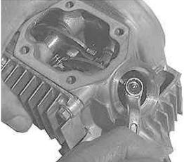
シリンダーヘッドに組まれているロッカーアームのタベットナットとボルトを取り外す。タベットナットを緩めた時点でタベットボルトをナットと一緒に取り外す。
