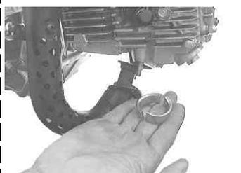
フランジのカラー2個をエキゾーストパイプを挟み込むようにして取り付ける。
