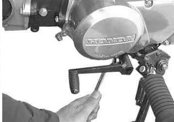
シフトペダルの6角ボルトを外しチェンジペダルを取り外す。
