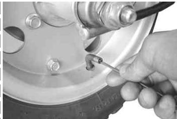
フロントタイヤの空気を抜く。(ドライバーの先などでバルブを押すとエアが抜けるのでシューという音がでなくなるまで押し続ける。)
