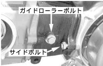
シリンダーのガイドローラーボルトとシリンダーとクランクケース間のサイドボルトを緩める。
