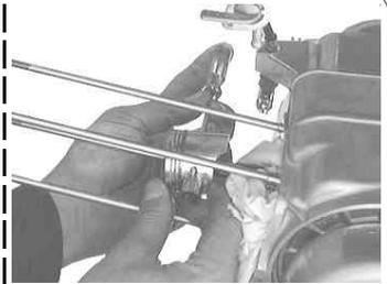
ピストンピンをサークリップが付いていない方向へ取り外す。サークリップが付いている方向からマイナスドライバーで押しあげると簡単にとれる。
