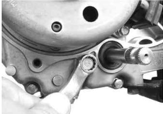
先程、取り外したチェンジベダルシャフト横の6角ボルトを取り付ける。
