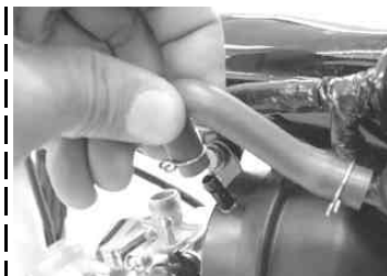
◇ストレージタンクのホース(フレームNo. AB 27-の車両の場合)を抜き取る。
