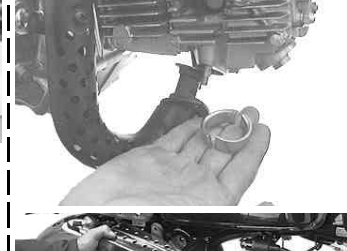
◇フランジのカラー2個を取り外し外側に引く様にしてマフラーを車体から取り外す。
