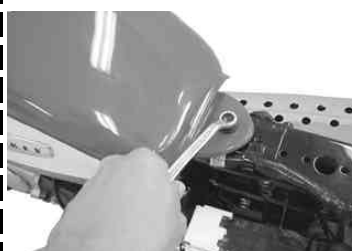
◇フューエルタンクをフレームにとめているボルトを取り外す。
