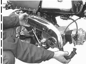
◇アース線をエアクリナーステー部のボルトでフレームに取り付ける。
