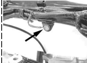
◇アース線をエアクリナーステー部のボルトでフレームに取り付ける。
