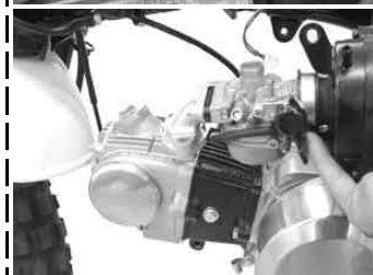
◇インレットパイプをシリンダーヘッドにとめているボルト2本を取り外しインレットパイプ、キャブレター、エアクリナーを取り外す。
