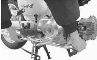
マフラーをブレーキペダルとステップの間に通し、フランジ部をシリンダーヘッドの排気出口付近まで持って行く。
