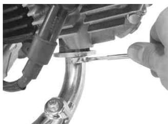
Eパイプ部のナット2個を反時計方向に回し取り外す。
