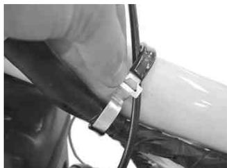
ワイヤーを束ねているベルトを外す。スロットルケーブルとチョークケーブルを取り付けたままキャブレターASSYを車体から離し左前方のウインカーに引っかけておく。
