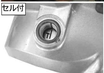
フライホイールのTマークをクランクケースの切り欠き部に合わせる。
