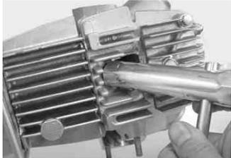
車載工具がプラグレンチを使いプラグを取り付ける。
