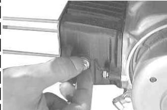
ゆるめておいたガイドローラーボルトとシリンダーサイドボルトを反時計方向に回し取り外す。
