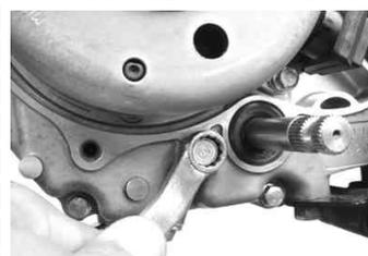
チェンジベダルシャフトの横に先程外したボルトを取り付け、締め付ける。
