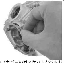
シリンダーヘッドカバーのガスケットとヘッドカバーを取り付ける。
