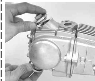
タペットキャップ2個を反時計方向に回し取り外す。
