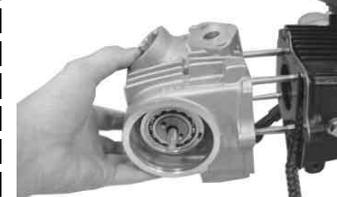
シリンダーヘッドをシリンダーから前方へ引っ張って取り外す。(かたい場合はシリンダーヘッドをプラスチックハンマーで軽くたたき、取り外す)ノックピン2個は再使用するので取り外しておく。
