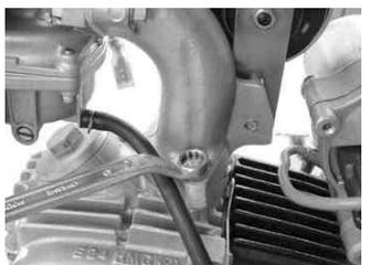
シリンダーヘッドとインレットパイプを止めているボルト2本を反時計方向に回し取り外す。
