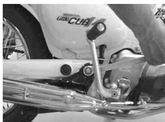
マフラー本体を止めている6角ボルトを反時計方向に回し取り外す。
