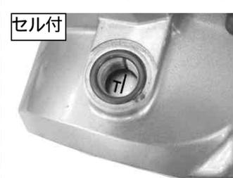
カムシャフトのOマークとフライホイールのTマークがそれぞれの切り欠きに合う様にして止める。磁石の反発でフライホイールはピッタリと止まらないがカムプロケットとフライホイールが同時に合えばOK。
