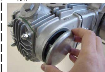
シリンダーヘッド左カバーガスケットと左カバーを取り付ける。(左サイドカバーがボルトを締めたときに左回りにしないように回り止めを合わせる)
