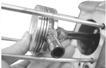
ピストンに三分の一程度ピストンピンを挿入しておいて取り付けるのも簡単な方法ではある。付属のピストンピンサークリップをサークリップ溝にきっちりめ込む。
