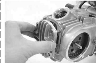
ヘッドカバーを取り外す。(かたい場合はプラスチックハンマーで軽くたたき、取り外す)シリンダーヘッドにガスケットが残った場合は、スクレーパーがカッター等できれいに取り除く。
