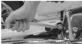
フランジ部と車体を止めるナットを締め付ける。
