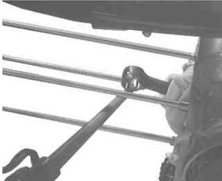
ピストンピン部とコンロッド小端部にエンジンオイルを塗りピストンピンを取り付ける。
