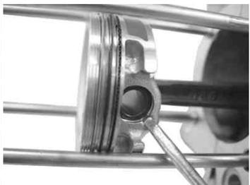
ドライバーでピストンにキズを付けないように押し込むと比較的簡単に取り付けられる。押し込み中にサークリップが外れて飛んでしまうことがあるので慎重に行う事。目に入らぬように防護メガネなどを着用する事。詰めていたウエスを取り外す。
