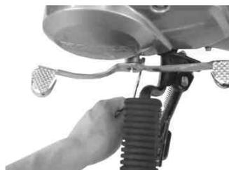
シフトペダルの6角ボルトを外しシフトペダルを手前側にスライドし、取り外す。
