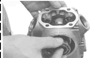
キットのシリンダーヘッドにカムシャフトをセットします。
