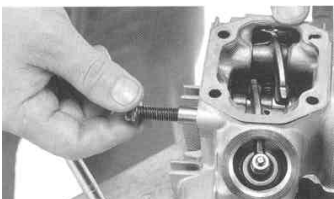
オリジナルのシリンダーヘッドのロッカーアームシャフトを取り外します。
