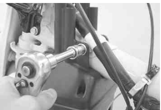
エアクリーナーをフレームに左右から1本ずつボルトで止める。 使用工具 10mmボックスレンチ&中ロングジョイント 締め付けトルク 10 N・m (1.0 kgf・m)
