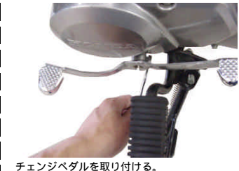
チェンジペダルを取り付ける。 使用工具 10mmメガネレンチ 締め付けトルク 10 N・m (1.0 kgf・m) エンジンやマフラー、インレットパイプ等、今まで付けたボルト類に緩みがないか確認する。
