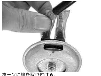
ホーンに線を取り付ける。
