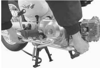
マフラーをブレーキペダルとステップの間に通し、フランジ部をシリンダーヘッドの排気出口付近まで持って行く。 マフラーガスケットをシリンダーヘッドとマフラーの間に挟み込む様に入れる。マフラー本体をピボットシャフトに取り付ける。マフラー本体を止めるナットを締める。(指で締まる程度に仮止め)
