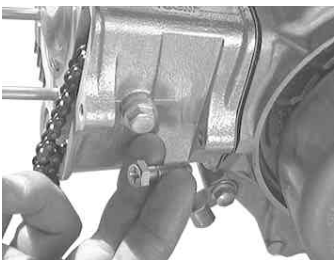
シリンダーサイドボルトを取り付ける。 (指で締まる程度まで仮止め)
