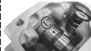
デコンプカムのストッパー部は燃焼室側に向けておきます。
