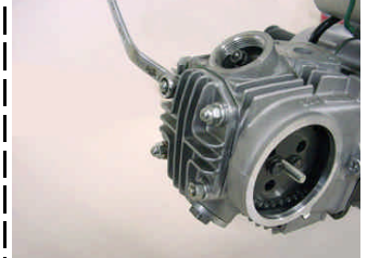
ヘッドナットを均等に締め付ける。 (トルクレンチがない場合は対角に少しずつしっかり締める)
