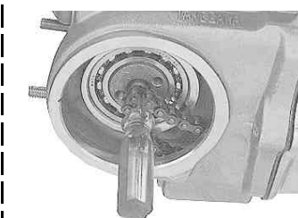
カムチェーンはシリンダーの方に落ちないようにカムシャフトの真ん中の穴にドライバー等を入れてカムチェーンを止めておく。
