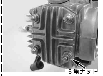
ヘッドカバーのワッシャとナットを取り付ける。 (エンジンを前から見て左下が銅ワッシャ残りの3つは鉄ワッシャ右下が六角ナット残りの3つがふくらナット)
