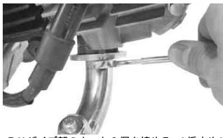
E Xパイプ部のナット2個を締める。(仮止め) 使用工具 10mmスパナ
