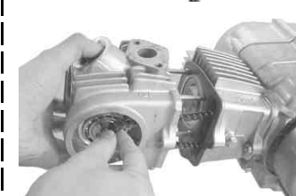
シリンダーヘッドをカムチェーンとスタッドボルトを通して取り付ける。
