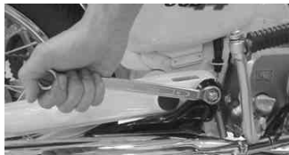
フランジ部と車体を止めるナットを締め付ける。 締め付けトルク: フランジ部 10 N・m (1.0 kgf・m) 本体部 36 N・m (3.5 kgf・m) 使用工具 14mmメガネレンチ リトルカブ 17mmメガネレンチ 仮止めの三カ所を締め付ける。
