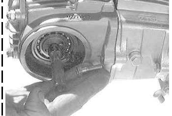
ヘッドサイドボルトを取り付ける。先に仮止めていたガイドローラーボルトとシリンダーサイドボルトを締め付ける。
