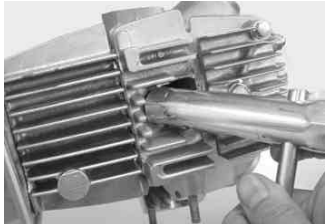
車載工具がプラグレンチを使いプラグを取り付ける。 使用工具 プラグレンチ 締め付けトルク 11 N・m (1.1 kgf・m) プラグキャップをプラグに取り付ける。
