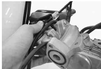
インレットパイプにOリングが付いている事を確認する。
