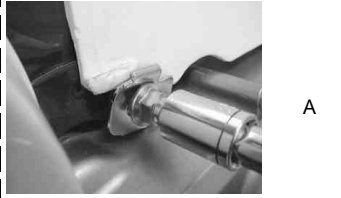
使用工具 A: 12mmボックスレンチ & 中ロングジョイント B: 10mmボックスレンチ & 中ロングジョイント C: 10mmボックスレンチ 締め付けトルク A : 20 N・m (2.0 kgf・m) B、C : 10 N・m (1.0 kgf・m)
