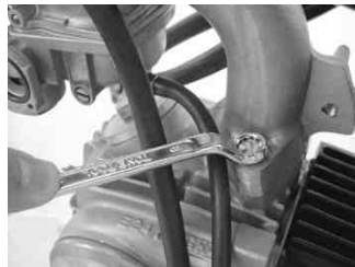
シリンダーヘッドとインテークマニホールドを止めているボルト2本を取り付ける。 使用工具 8mmメガネレンチ 締め付けトルク 10 N・m (1.0 kgf・m)
