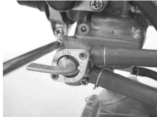
フューエルロックを2本のネジで取り付け。 使用工具 プラスドライバー
