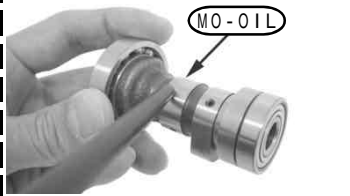
カム山にモリブデン溶液を塗布します。
