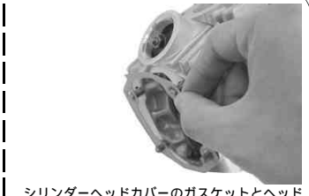
シリンダーヘッドカバーのガスケットとヘッドカバーを取り付ける。
