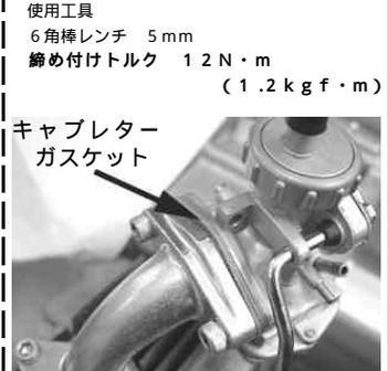
PC18キャブレターとインテイクマニホールドにキャブレターガスケットをはさみ、ソケットキャップスクリュー  $6 \times 2.0$  2本で取り付ける。
