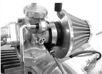
バンドをエアークフィルターの付け、キャブレターに差し込む。バンドを締め付ける。
