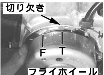
フライホイールのTマークとカムプロケットのOマークが各切り欠きに合う様にフライホイールを反時計方向に回転させて合わせる。
