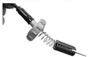
スロットルケーブルにトップキャップを取り付け、スプリングを入れてインナーケーブルにスロットルバルブを取り付ける。
