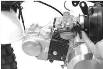
インレットパイプをシリンダーヘッドにためているボルト2本を取り外しインレットパイプ、キャブレター、エアクリーナーを取り外す。
