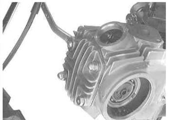
シリンダーヘッドカバーを止めているナット4個を対角の順番に反時計方向へ回し取り外す。ナット下にあるワッシャ4枚を取り外す。
