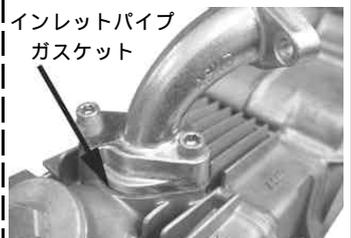
インテイクマニホールドとシリンダーヘッドにインレットパイプガスケットをはさみ、ソケットキャップスクリュー  $6 \times 2.5$  2本で取り付ける。
