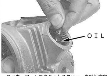
ロッカーアームのタペットスクリューを時計方向に回して取り付ける。
