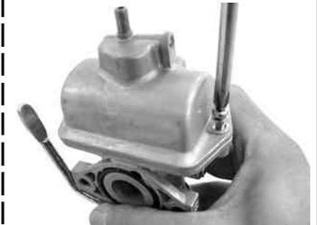
フロートチャンバーを取り付け、2本のスクリューでキャブレターに取り付ける。
