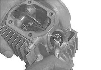
シリンダーヘッドに組まれているロッカーアームのタペットアジャスティングナットとタペットアジャスティングスクリューを取り外す。タペットアジャスティングナットを緩めた時点でタペットアジャスティングスクリューと一緒に取り外す。
