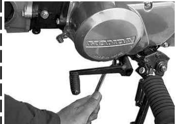
シフトペダルの6角ボルトを外しシフトペダルを取り外す。
