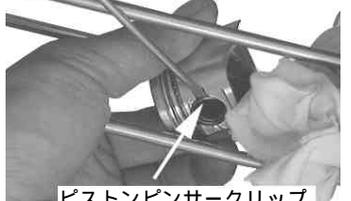
ピストンピンサークリップの片側を取り外す。ピストンピン穴の切り欠き部を利用してこじるようにすると外れる。
