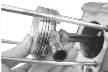
ピストンに三分の一程度ピストンピンを挿入しておいて取り付けるのも簡単な方法ではある。付属のピストンピンサークリップをサークリップ溝にきっちりはめ込む。
