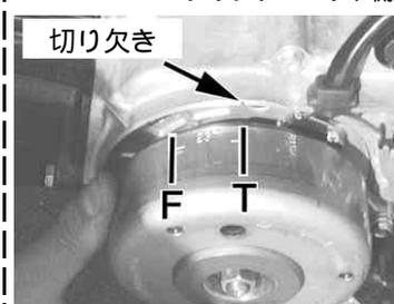
カムプロケットのOマークとフライホイールのTマークがそれぞれの切り欠きに合う様にして止める。磁石の反発でフライホイールはピッタリと止まらないがカムプロケットとフライホイールが同時に合えばOK。
