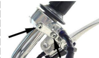
アッパースロットルハウジングを2本のスクリューで取り付ける。
