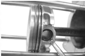
ドライバーでピストンにキズを付けないように押し込むと比較的簡単に取り付けられる。押し込み中にサークリップが外れて飛んでしまうことがあるので慎重に行う事。目に入らぬように防護メガなどを着用する事。詰めていたウエスを取り外す。
