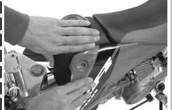
シュラウドを引っ張りながら取り付け穴を燃料タンクのネジ穴に合わせてスクリュー2本を取り付ける。取り付けにくい場合は、ヤスリ等で長穴加工して下さい。
