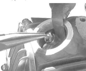
ロッカーアームのタペットアジャスティングスクリューを締め込んでいきタペットアジャスティングスクリューとバルブシステムエンドの間に0.05ミリのシクネスゲージを入れて少し抵抗があるくらいで引き抜ける様に合わせてタペットアジャスティングナットを締め付ける(少し抵抗があるというのがわからない場合0.07と0.03のシクネスゲージを用意して0.07がすき間に入らず0.03がゆるく入る様に合わせればだいたい0.05ミリということになる)IN・EX共に0.05ミリに合わせる。
