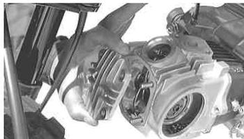
ヘッドカバーを取り外す。(かたい場合はプラスチックハンマーで軽くたたき、取り外す)シリンダーヘッドにガスケットが残った場合は、スクレーパーかカッター等できれいに取り除く。
