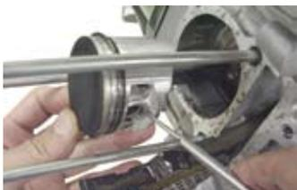
◇サークリップを取り外した方へピストンピンをドライバー等で押して外し、ピストンを外す。
