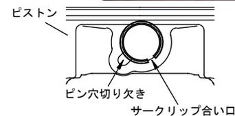
◇図を参考にしてピストンリングを取り付ける。エキスパンダー、サイドレール、トップリングの順に取り付ける。
