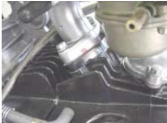
◇エアクリーナーダクトのクランプスクリューを締め込む。フューエルホースを接続し、チューブクランプを取り付ける。フューエルホースとスパークプラグコードにクランプを取り付ける。
