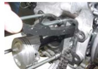
◇シリンダーの内側にエンジンオイルを塗布し、均等に薄く塗り広げる。ピストンの全周面と、ピストンリングにエンジンオイルを塗布する。
