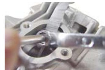
◇クランクシャフトを反時計方向に2回転まわし、バルブ隙間が変化していないか確認する。
