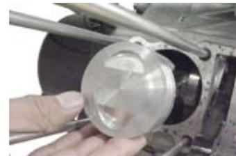
◇付属のピストンピンサークリップを取り付ける。
