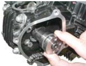
◇ロッカーアームを手で持ち、ロッカーアームシャフトをシリンダーヘッドに差し込み、取り付ける。
