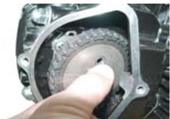
◇カムシャフトスプロケットの穴にカムシャフトのネジ穴を合わせ、スクリュー2本を取り付ける。
