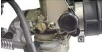
◇スロットルバルブの切り欠きをキャブレターのアイドルストップスクリューに合わせて差し込み、キャブレタートップを取り付ける。配線2本を接続する。
