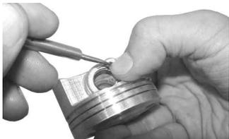
ピストンピンサークリップの合い口は切り欠き部を避けて取り付けること。
