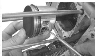
サークリップを取り外した方へピストンピンをドライバー等で押して外し、ピストンを外す。
