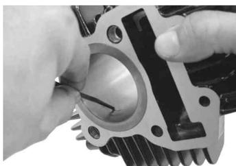
シリンダーをピストンリングの合い口の位置がずれないように指で少しずつピストンにはめていき、シリンダーをクランクケースにはめ込む。
