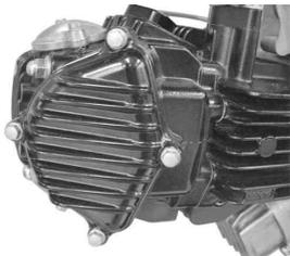
フライホイールを反時計方向に回し、カムスプロケットの“T”マークをシリンダヘッドの突起に合わせる。
