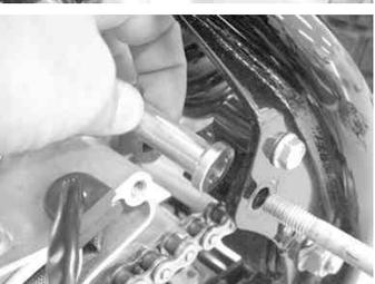
下側のボルトを抜き取り、エンジンをフレームの左側から取り外します。フレーム等に傷をつけないように注意して下さい。
