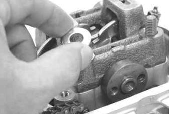
ナット 4個を対角に数回に分けて均等に締め付けます。
