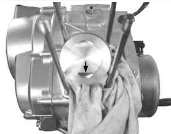
付属のピストンピンサークリップを取り付けます。ピストンピンサークリップの合い口は切り欠き部を避けて取り付けして下さい。ドライバーで、ピストンにキズを付けないように押し込むと比較的簡単に取り付けことが出来ます。押し込み中にピストンピンサークリップが外れて飛んでしまう恐れがあるので、慎重に取り付けて下さい。
