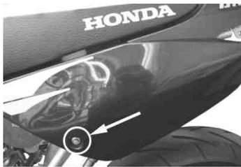
シート裏側にあるフランジナットとリアフェンダーサイド部のフランジボルトを取り外し、シートとリアフェンダーを取り外します。
