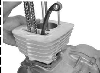
カムチェーンガイドの先端をクランクケースの溝に、突起部をシリンダーの溝に合わせようようにして差し込みます。
