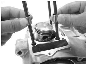
ロックナットとアジャストボルトをシリンダーから取り外します。
