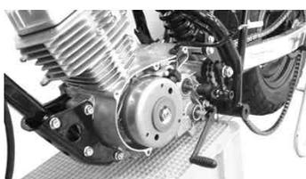
フロントエンジンハンガーのナット4個を取り外し、ボルト4本を抜き取ってフロントエンジンハンガーを取り外します。
