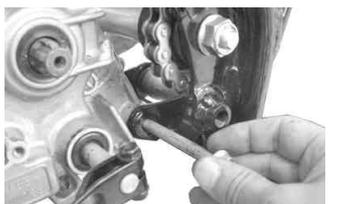
カラーとクラッチケーブルガイドを取り付け、リアエンジンマウントの上側にボルトを左側から差し込みます。
