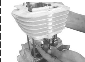
シリンダーにピストンリングの合い口がずれないように指で少しずつはめていきます。
