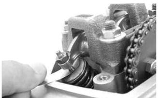
引き抜くときに少し抵抗があるぐらいにアジャストスクリューを合わせ、ナットを締め付けます。
