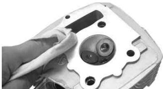
ノックピン 2個とシリンダーヘッドガスケットをシリンダーに取り付けます。
