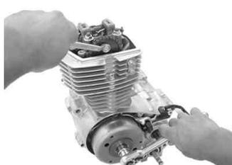
ロックボルトとセットプレートを取り外し、アジャスターを取り外します。
