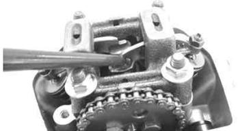
シリンダーヘッドカバーとガスケットをシリンダーヘッドカバーボルト2本でシリンダーヘッドに取り付けます。
