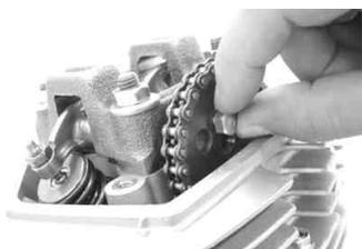
カムsprocketをカムシャフトから外し、カムチェーンから外します。
