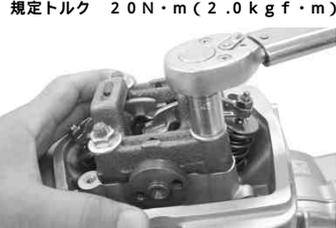
仮止めしていたシリンダーヘッドマウントボルトを本締めします。
