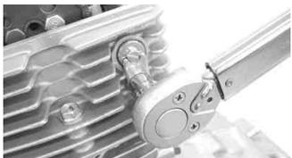
アジャスターの調整だけではガタが無くない場合、シリンダーのアジャストボルトでも調整を行います。
