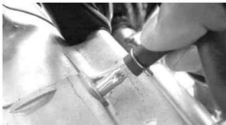
クラッチケーブルガイドのナットをゆるめ、リフターレバーからクラッチケーブルの接続を外します。
