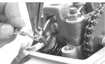
ナットを締め付け後、0.05 mm のシクネスゲージを再度差し込み、バルブ隙間を確認します。シリンダーヘッドのオイル溜りにきれいなエンジンオイルをいっぱいまで入れます。
