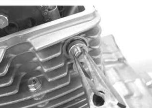
カムsprocketの6角ボルト2本を取り外します。
