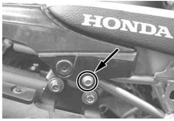
フューエルタンクを取り付けてあるフランジボルトを取り外し、フューエルタンクを後方に引いて取り外します。
