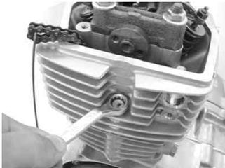
カムシャフトホルダーナット4個を対角に数回に分けてゆるめてワッシャ4個、カムシャフトホルダー、カムシャフト、ノックピンを取り外します。
