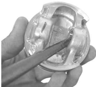
コンロッドのピストンピン穴にエンジンオイルを塗布します。
