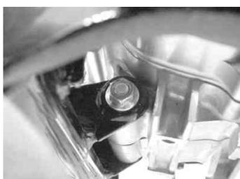
まず、上側のボルトを抜き取り、カラー(Aペの場合)とクラッチケーブルガイドを取り外します。
