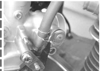
インシュレーターCOMPをインレットパイプに差し込み、バンドで締め付けます。
