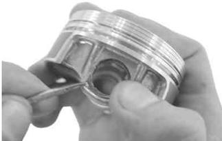
図を参考にしてピストンリングを取り付けます。
