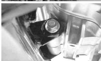
フロントエンジンハンガーを取り付け、ボルト4本を左側から差し込み、ナット4個を仮止めします。
