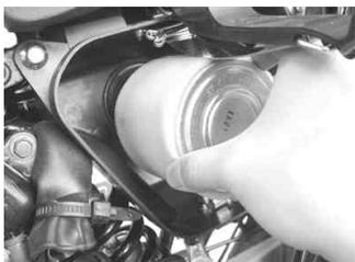
コネクティングチューブにストレージタンクホースを取り付け、チューブクリップを取り付けます。エアイベントチューブは走行に支障の無いようにまとめて下さい。
