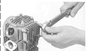
キット内の右サイドカバーガスケットをキット内の右サイドカバーにセットし、シリンダーヘッドにキット内のフランジボルト2本を用いて取り付け、規定トルクまで締め付けます。
