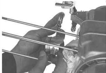
ピストンピンをピストンピンサークリップが付いていない方向へ取り外す。ピストンピンサークリップの付いている方向からマイナスドライバーで押してあげると簡単にとれる。
