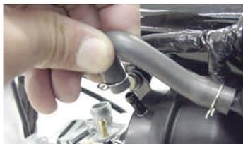
ストレージタンクのホース(フレームNo AB 27-の車両の場合)を抜き取る。
