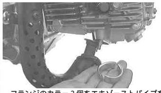
フランジのカラー2個をエキゾーストパイプを挟み込むようにして取り付ける。
