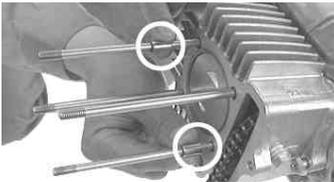
シリンダーにノックピン2個を取り付ける。
