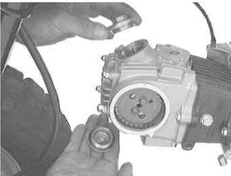
タベットキャップ2個を反時計方向に回し取り外す。
