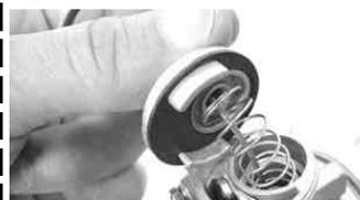
キャブレターのくぼみにトップキャップの凸を合わせて取り付ける。
