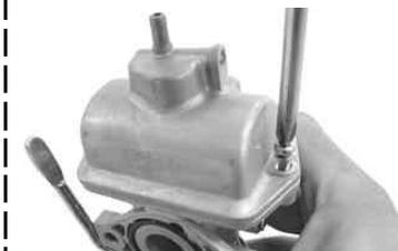
フロートチャンバーを取り付け、2本のスクリューでキャブレターに取り付けます。
