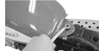
フューエルタンクをフレームにボルトで取り付け
