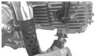
EXパイプ部のナット2個を締める。(仮止め)
