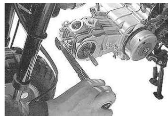
ヘッドナットを均等に締め付ける。(トルクレンチがない場合は対角に少しずつしっかり締める)
