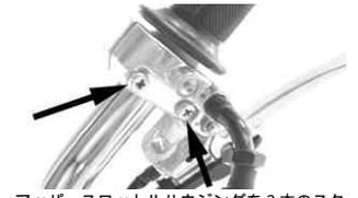
アッパースロットルハウジングを2本のスクリューで取り付ける。
