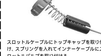
スロットルケーブルにトップキャップを取り付け、スプリングを入れてインナーケーブルにスロットルバルブを取り付ける。
