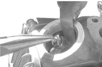
ロッカーアームのタペットアジャスティングスクリューを締め込んでいきタペットアジャスティングスクリューとバルブシステムエンドの間に0.05ミリのシクネスゲージを入れて少し抵抗があるくらいで引き抜ける様に合わせてタペットアジャスティングナットを締め付ける(少し抵抗があるというのわからない場合0.07と0.03のシクネスゲージを用意して0.07がすき間に入らず0.03がゆるく入る様に合わせればだいたい0.05ミリということになる)
