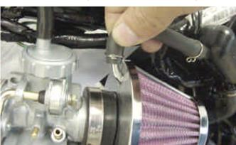
ストレージタンクのホースをエアフィルターに取り付ける。(フレームNO. AB27の車両の場合)
