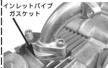
インテイクマニホールドとシリンダーヘッドにインレットパイプガスケットをはさみ、ソケットキャップスクリュー6×25 2本で取り付ける。
