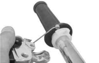
スロットルパイプからスロットルケーブルのインナーケーブルを外す。
