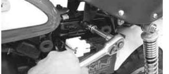
シート下にボルトを差し込み、ナットを取り付ける。
