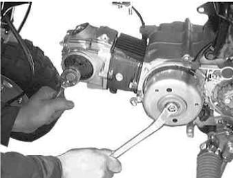
フライホイールを固定しカムスプロケット6角ボルト2個を反時計方向に回し取り外す。
