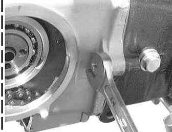
シリンダーヘッドとシリンダーを止めているシリンダーヘッドサイドボルトを反時計方向に回し取り外す。
