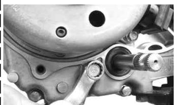
先程、取り外したチェンジバルドシャフト横の六角ボルトを取り付ける。
