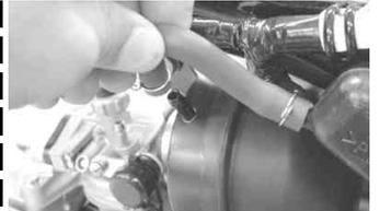
ストレージタンクのホース(フレームNO. AB27-の車両)を取り付ける。
