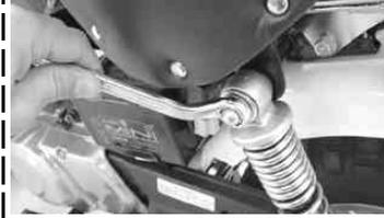
リアショックのナット2個を締め付ける。
