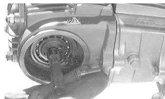
ヘッドサイドボルトを取り付ける。先に仮止めていたガイドローラーボルトとシリンダーサイドボルトを締め付ける。
