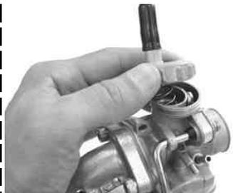
PC18キャブレターのトップキャップを外し、スプリング、スロットルバルブを抜き取る。
