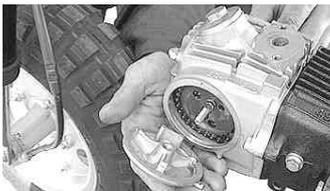
シリンダーヘッド左カバーガスケットと左カバーを取り付ける。
