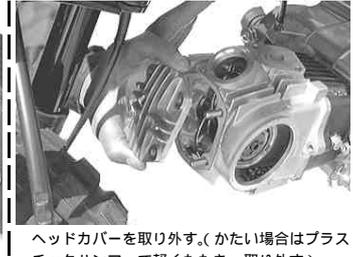
ヘッドカバーを取り外す。(かたい場合はプラスチックハンマーで軽くたたき、取り外す) シリンダーヘッドにガスケットが残った場合は、スクレーパーかカッター等できれいに取り除く。
