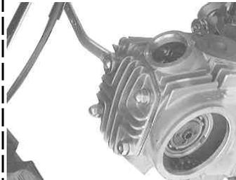
シリンダーヘッドカバーを止めているナット4個を対角の順番に反時計方向へ回し取り外す。ナット下にあるワッシャ4枚を取り外す。
