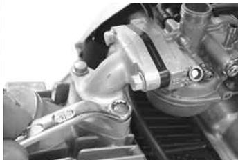
インレットパイプをシリンダーヘッドにとめているボルト2本を取り外しインレットパイプ、キャブレター、エアクリーナーを取り外す。
