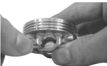
ピストンピンサークリップの合い口は切り欠き部を避けて取り付ける事。
