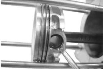
ドライバーでピストンにキズを付けないように押し込むと比較的簡単に取り付けられる。押し込み中にサークリップが外れて飛んでしまうことがあるので慎重に行う事。目に入らぬように防護めがねなどを着用する事。詰めていたウエスを取り外す。
