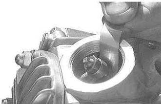
タペットすき間が変化していないか点検しすき間が合っていればOK、くるとしている場合は再度調整する。
