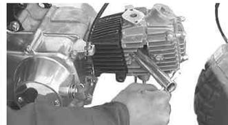
車載工具かプラグレンチを使いプラグを取り付ける。
