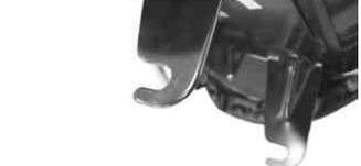
リアショックの2枚のワッシャの間にシートステーのフックを差し込み、取り付けれる。
