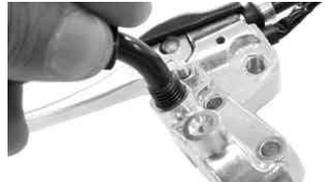
キット内のスロットルケーブルをロアスロットルハウジングに取り付ける。
