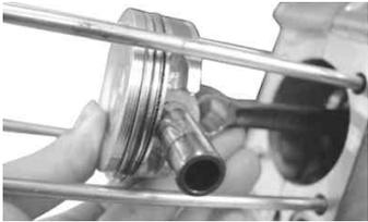
ピストンに三分の一程度ピストンピンを挿入しておいて取り付けるのも簡単な方法ではある。付属のピストンピンサークリップをサークリップ溝にきっちりはめ込む。
