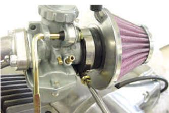
バンドをエアフィルターに付け、キャブレターに差し込む。バンドを締め付ける。
