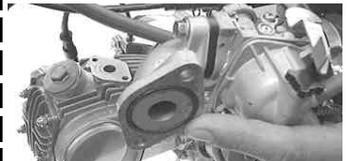
インレットパイプにOリングが付いていることを確認する。(フレームNO. Z50Jの車両)
