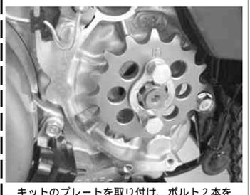
キットのプレートを取り付け、ボルト2本を取り付ける。
