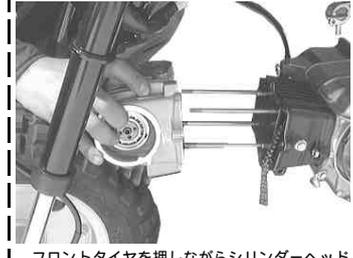
フロントタイヤを押しながらシリンダーヘッドを取り外す。ここでタイヤの空気を抜いた訳をご理解いただきたいと思います。ノックピン2個は再使用するの取り外しておく。
