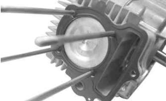
ヘッドガスケットを取り付ける。
