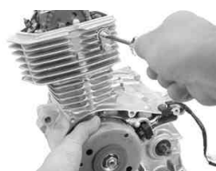
アジャスター 緩む 標準位置 張る セットプレート ロックボルト
