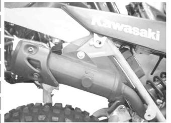
ナットとボルトを締め付ける。
