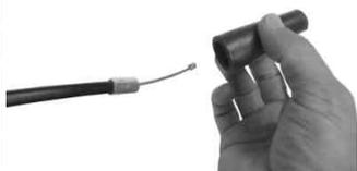
付属のスロットルケーブルからブーツを取り外し、ノーマルのスロットルケーブルのブーツを取り付ける。
