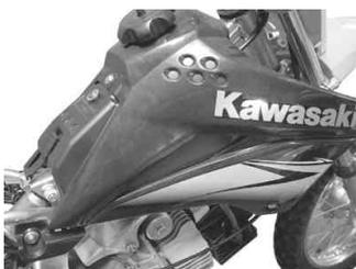
シート、シートカウルを取り付け、4本のボルトを取り付ける。
