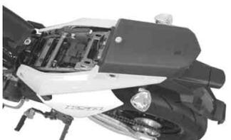
3本のボルトを外し、右のシュラウドを取り外す。'11、'12 KSR110フューエルエバポレーティングシステム装備車両の場合は左右のシュラウドを取り外す。
