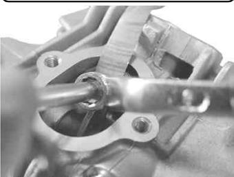
クランクシャフトを反時計方向に 2 回転まわし、バルブ隙間が変化していないか確認する。隙間が変化している場合は再度調整する。この作業を合うまで繰り返す。カムシャフトスプロケットカバーをボルト 4 本で、バルブアジャスターカバー I N 側、E X 側をボルト 2 本で取り付ける。
