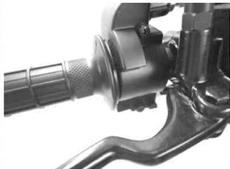
スロットルリールからインナーケーブルの接続を外し、スロットルハウジングからノーマルのスロットルケーブルを取り外す。ノーマルスロットルケーブルを車両から取り外す。ノーマルのスロットルケーブルのブーツをキャブレター側から取り外す。
