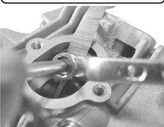
クランクシャフトを反時計方向に2回転まわし、バルブ隙間が変化していないか確認する。隙間が変化している場合は再度調整する。この作業を合うまで繰り返す。カムシャフトスプロケットカバーをボルト4本で、バルブアジャスティングカバーIN側、EX側をボルト2本で取り付ける。
