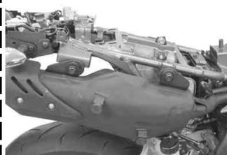
二次空気供給ホースをエキゾーストパイプに接続し、ホースクリップを止める。
