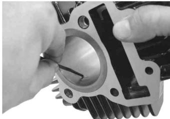
シリンダーをピストンリングの合い口の位置がずれないように指で少しずつピストンにはめていき、シリンダーをクランクケースにはめ込む。シリンダーがピストンにはまったら、カムチェーンをシリンダーに通しておく。
