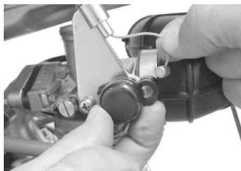
クランプを取り外す。チューブクランプを取り外し、フューエルホースの接続を外す。エアクリーナダクトのクランプスクリューを緩める。
