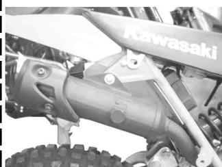
ナットとボルトを締め付ける。
