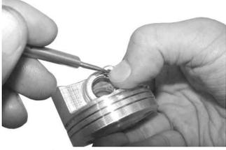
ピストンピンサークリップの合い口は切り欠き部を避け、ピストン往復運動方向に向けて取り付けること。
