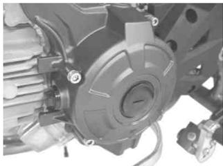
フライホイールを反時計方向に回し、カムスプロケットの“ ”マークをシリンダーヘッドの突起に合わせる。
