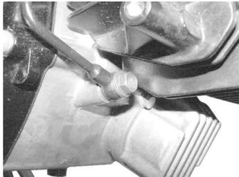
ヘッドボルト2本を取り外す。ヘッドナット4個を対角に数回に分けて緩め、取り外す。
