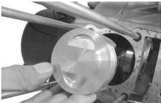
付属のピストンピンサークリップを取り付ける。
