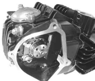
ロッカーアームを手で持ち、ロッカーアームシャフトを引き抜いてIN側、EX側のロッカーアームを取り外す。
