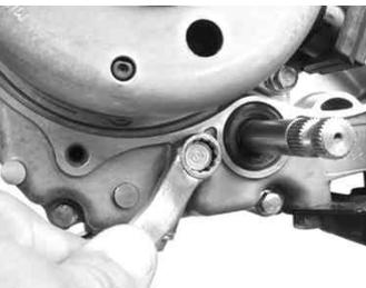
チェンジベダルシャフトの横に先程外したボルトを取り付け、締め付ける。
