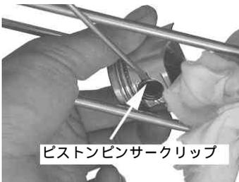
ピストンピンサークリップの片側を取り外す。ピストンピン穴の切り欠き部を利用してこじると外れます。
