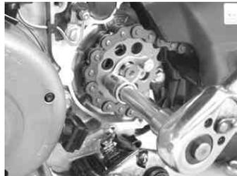
仮止めしていたドライブスプロケットのボルトを
