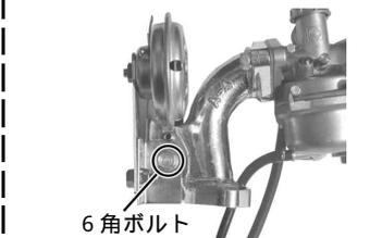
インレットパイプにフューエルチューブクランプをSTDのボルトを使用して取り付け、規定トルクで取り付け。
