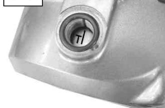
カムシャフトのOマークとフライホイールのTマークがそれぞれの切り欠きに合う様にして止める。磁石の反発でフライホイールはピッタリと止まらないがカムプロケットとフライホイールが同時に合えばOK。
