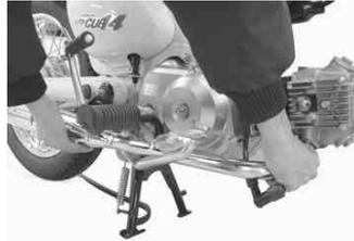
マフラーをブレイキベダルとステップの間を通し、フランジ部をシリンダーヘッドの排気出口付近まで持っていく。
