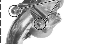
キャブレターとインレットパイプでキャブレターガスケットを挟み、ソケットキャップスクリュー 6 x 2.5 で取り付け、規定トルクで締め付ける。
