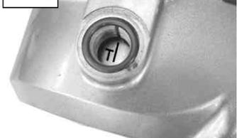
フライホイールのTマークをクランクケースの切り欠き部に合わせる。
