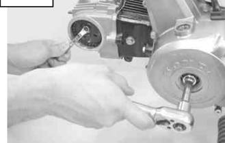
フライホイールを固定してカムプロケットボルトを2本締め付ける。
