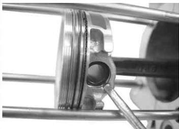
ドライバーでピストンにキズを付けないように押し込むと比較的簡単に取り付けられる。押し込み中にサークリップが外れて飛んでしまうことがあるので慎重に行う事。目に入らぬように防護メガネなどを着用する事。詰っていたウエスを取り外す。
