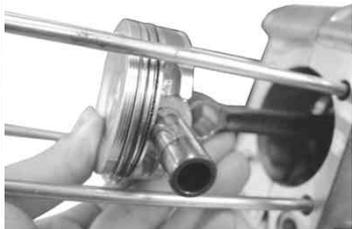
ピストンに三分の一程度ピストンピンを挿入しておいて取り付けするのも簡単な方法ではある。付属のピストンピンサークリップをサークリップ溝にきっちりはめ込む。
