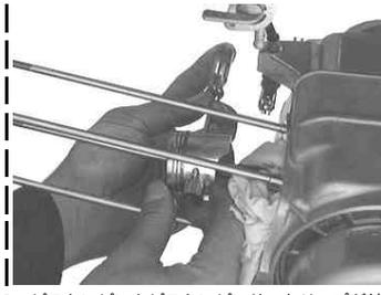
ピストンピンをピストンピンサークリップが付いていない方向へ取り外す。ピストンピンサークリップの付いている方向からマイナスドライバーで押してあげると簡単にとれる。
