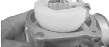
P B 16 キャブレターのフロートチャンバーを外し、付属のメインジェット#90とスロージェット#38に交換してフロートチャンバーを元通りに取り付け。
