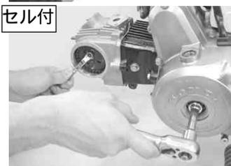
フライホイールを固定しカムスプロケット6角ボルト2個を反時計方向に回し取り外す。
