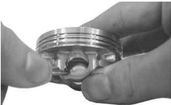
ピストンピンサークリップの合い口は切り欠き部を避けて取り付けする事。
