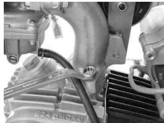
シリンダーヘッドとインレットパイプを止めているボルト2本を反時計方向に回し取り外す。
