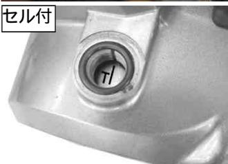
フライホイールのTマークとカムスプロケットのOマークが各切り欠きに合う様にフライホイールを反時計方向に回転させて合わせる。
