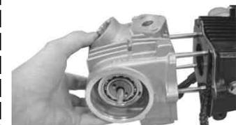
シリンダーヘッドをシリンダーから前方へ引っ張って取り外す。(かたい場合はシリンダーヘッドをプラスチックハンマーで軽くたたき、取り外す) ノックピン2個は再使用するので取り外しておく。
