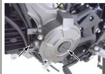
◇フライホイールを反時計方向に回し、カムプロケットの“—”マークをシリンダーヘッドの突起に合わせる。
