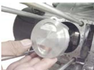
◇付属のピストンピンサークリップを取り付ける。
