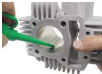
◇シリンダーをピストンリングの合い口の位置がずれないように指で少しずつピストンにはめていき、シリンダーをクランクケースにはめ込む。シリンダーがピストンにはまったら、カムチェーンをシリンダーに通しておく。
