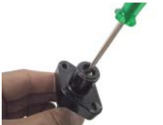
◇カムチェーンテンショナーをマークが車両前方を向くようにシリンダーにセットし、ネジロック剤を塗布したボルト2本にて取り付ける。
