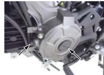
◇カムプロケットカバーをボルト4本で、バルブアジャスティングカバー IN側、EX側をボルト2本で取り付ける。
