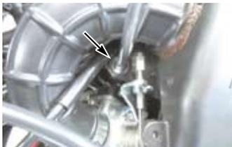
◇コネクティングチューブとスロットルボディを接続し、バンドのクランプを締め付ける。ハイテンションコードのクランプをエアクリーナーに取り付ける。
