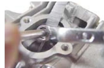
◇クランクシャフトを反時計方向に2回転まわし、再度カムプロケットとフライホイールの合わせマークを合わせ、バルブクリアランスが変化していないか確認する。クリアランスが変化している場合は再度調整する。この作業を合うまで繰り返す。
