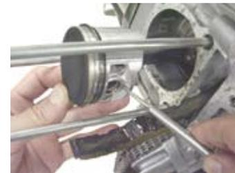
◇サークリップを取り外した方へピストンピンをドライバー等で押して外し、ピストンを外す。
