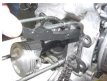
◇シリンダーの内側にエンジンオイルを塗布し、均等に薄く塗り広げる。ピストンの全周面と、ピストンリングにエンジンオイルを塗布する。
