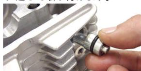
ロックボルトでセットプレートを仮止めします。
