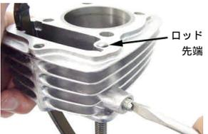
詰っていたウエスを取り外します。クランクケースとシリンダーの合せ面をシンナー等で脱脂します。
