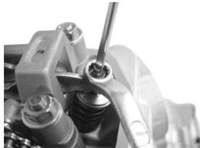
ナットを締め付け後、シクネスゲージを再度差し込み、バルブ隙間を確認します。
