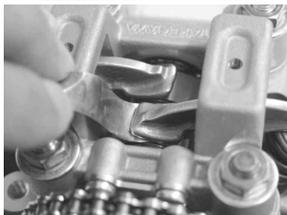
アジャストスクリューを合わせ、アジャストナットを締め付けます。
