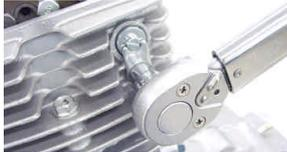
アジャスターの調整だけではガタが無くならない場合、シリンダーのアジャストボルトで調整を行います。
