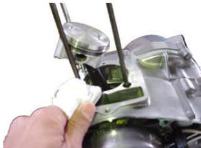
ロックピン2個とシリンダーガスケットをクランクケースに取り付けます。
