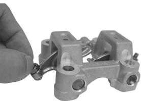
キットのカムシャフトのカム面にエンジンオイル又は、モリブデン溶液を塗布し、カムシャフトのカム山は下側に向けシリンダーヘッドに取り付けます。
