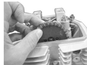
カムシャフトのボルト穴をカムスプロケットに合わせて六角ボルト2本を、仮止めします。このとき、ノックボルト(黒色ボルト)をインテーク側に取り付けます。
