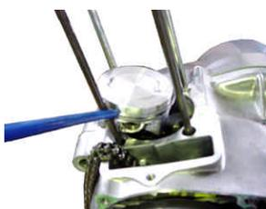
シリンダーにピストンリングの合い口がずれないようシリンダーを取り付けます。
