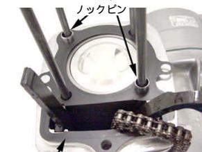
シリンダーヘッドガスケットカムチェーンをシリンダーヘッドに通し、シリンダーヘッドを取り付けます。
