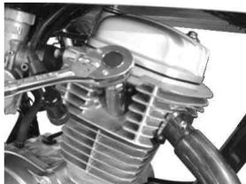
新品のスパークプラグを使用する場合は、耐熱潤滑剤等をスパークプラグネジ部に少量塗布し、締め付ける事をお勧めします。
