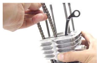
カムチェーンガイドの先端をクランクケースの溝に、突起部をシリンダーの溝に合わせるようにして差し込みます。
