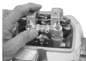
ワッシャ4個を取り付け、ナット4個の座面にエンジンオイルを少量塗布し、対角に数回に分けて均等に締め付けます。
