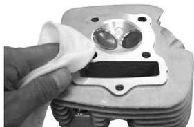
ノックピン2個とシリンダーヘッドガスケットをシリンダーに取り付けます。
