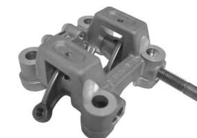
取り外したSTDロッカーアームからアジャスターボルトと、アジャスターナットをキットパーツのロッカーアームにエンジンオイルを塗布し、取り付けます。
