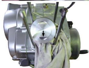
付属のピストンピンサークリップを取り付けます。ピストンピンサークリップの合い口は切り欠き部を避けて取り付けして下さい。
