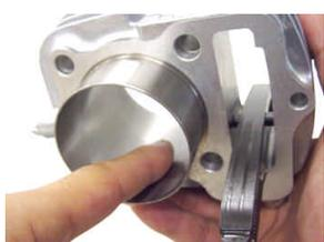
ピストンの全周面と、ピストンリングにエンジンオイルを塗布します。
