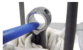
ピストンピンにエンジンオイル又はモリブデン溶液を塗布し、ピストンの上面の が、排気側を向くようにピストンを取り付けます。
