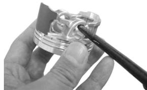
コンロッドのピストンピン穴にエンジンオイルを塗布します。
