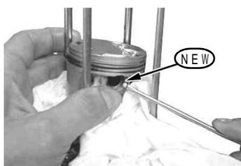
詰めていたウエスを取り外します。クランクケースのシリンダーベース面をきれいに脱脂し、ノックピン穴に、ノックピン8×12を取り付けます。
