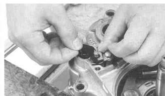
クランクケースガasketのホール部分と、シリンダー合わせ面をカッター等で切り落とし、フラットに仕上げます。クランクケース内にガasketくずが入らない様、注意すること。
