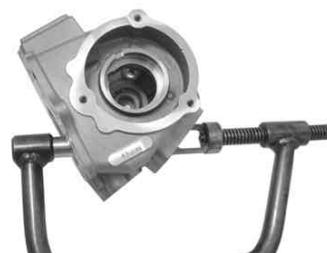
各バルブの曲がり、焼き付き、損傷を点検する。
