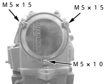
キット内のインスペクションキャップOリングに少量のエンジンオイルを塗布し、ブリーザーキャップと、インスペクションキャップに取り付け、インテーク側にブリーザーキャップを、エキゾースト側にインスペクションキャップをキット内のキャップスクリューM5 × 15を用いて取り付け、規定トルクまで締め付けます。
