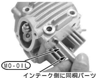
シリンダー上面をよく脱脂します。シリンダーにキット内の8×14のノックピンをノックピン穴にセットし、シリンダーに、キット内のシリンダーヘッドガスケットを取り付けます。
