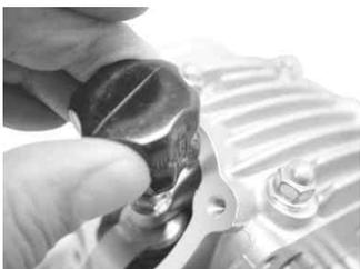
アジャストナットを規定トルクまで締め付けます。
