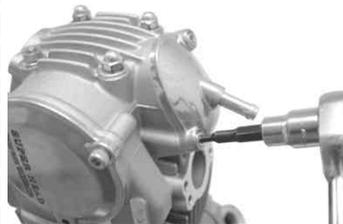
カムチェーンテンショナー部のサイドボルト穴からエンジンオイルを注入し、サイドボルトを締め付けます。
