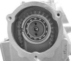
キット内のカムシャフトサークリップを取り付け、カムシャフトを止めます。この時、シリンダーヘッドカム穴の切り欠き部を避ける様に、サークリップの合い口を合わせます。
