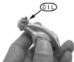
スーパーヘッドにロッカーアームを取り付けます。オリジナルのロッカーアームシャフトに、モリブデン溶液を塗布し、エキゾースト側に取り付け、キット内のロッカーアームシャフトにもモリブデン溶液を塗布し、切り裂き部分が有る方をカムチェーン側方向に取り付けます。
