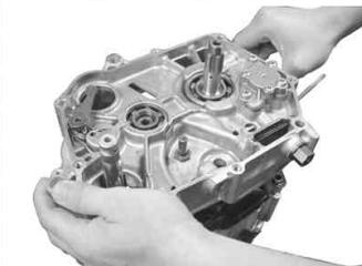
クランクケースボルトのネジ部に少量のアルミスPECIALを塗布し、クランクケースにボルトをセットし、対角線上に規定トルクまで締付けます。
