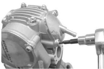
カムチェーンテンショナー部のサイドボルト穴からエンジンオイルを注入し、サイドボルトを締め付けます。
