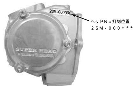
シリンダーヘッド左側面に打刻してあるNoをひかえる。
