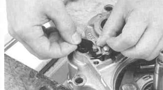
クランクケースガasketのホール部分と、シリンダー合わせ面をカッター等で切り落とし、フラットに仕上げます。クランクケース内にガasketくずが入らない様、注意すること。
