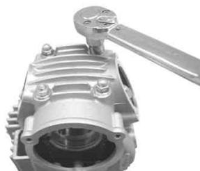
シリンダーサイド部のサイドボルト及びシリンダーヘッドサイド部のキャップスクリューを規定トルクまで締め付けます。
