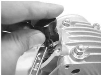
キット内の左サイドカバーOリングに少量のエンジンオイルを塗布し、左サイドカバーに取り付け、キット内のキャップスクリューM5 × 15 2本とM5 × 10 1本を用いて、シリンダーヘッドに取り付け規定トルクまで締め付けます。(ネジ位置に注意)
