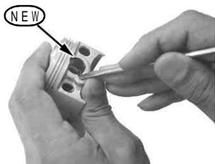
ピストンピンサークリップの合い口は、ピストンピン穴の切り欠き部を避け、ピストンに対して上下方向に合わせます。
