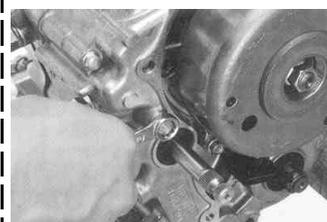
カムチェーンをカムスプロケットに取り付け、キット内のカムスプロケットプレート、キャップスクリューM5×12(黒色)2本を用いて取り付けます。
