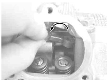
ストッパープレートをキット付属のソケットキャップスクリュー 6 x 10 を使用して取り付ける。
