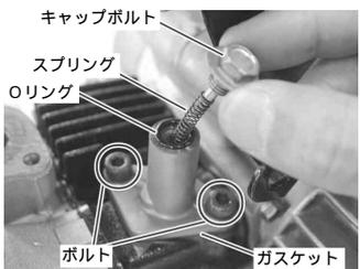
ボルトを取り外し、カムチェーンテンショナーをシリンダーヘッドから取り外す。カムスプロケットボルトを取り外してブリーザープレート / カムスプロケットを取り外す。
