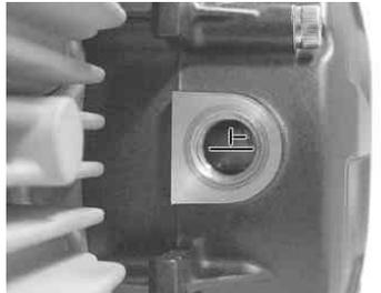
文字面を外側に向け、カムスプロケットの“ ”マークがシリンダーヘッドの突起に合うようにカムチェーンを取り付ける。カムスプロケットをカムシャフトにはめ込む。
