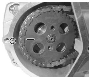
カムシャフトスプロケットの穴にカムシャフトのネジ穴を合わせ、付属のソケットキャップスクリュー6×10 2本を取り付ける。
