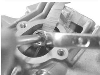
クランクシャフトを反時計方向に2回転まわし、バルブクリアランスが変化していないか確認する。
