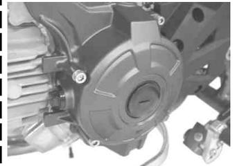
カムシャフトスプロケットカバーをボルト4本で、バルブアジャスティングカバーIN側、EX側をボルト2本で取り付け。
