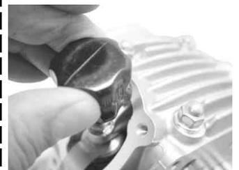
アジャストナットを規定トルクまで締め付けます。
