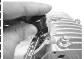
左サイドカバーリングに少量のエンジンオイルを塗布し、左サイドカバーに取り付け、キャップスクリューM5×15 2本とM5×10 1本を用いて、シリンダーヘッドに取り付け規定トルクまで締め付けます。
