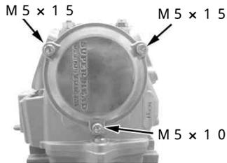
インスペクションキャップリングに少量のエンジンオイルを塗布し、インスペクションキャップに取り付け、インスペクションキャップをキャップスクリューM5×15を用いて取り付け、規定トルクまで締め付けます。
