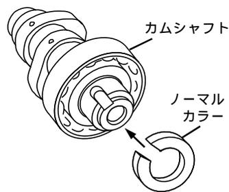
カムシャフトCOMPベアリング部にエンジンオイルを差し、カム山を燃焼室側に向くように、シリンダーヘッドに取り付けセットします。
