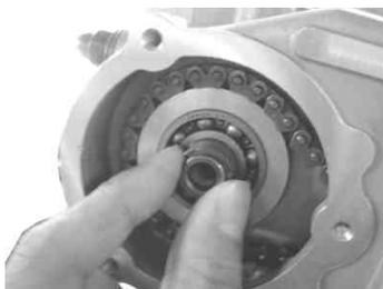
キット内のC型リングを取り付け、カムシャフトを止めます。(C型リング角の面取りの有る方をベアリング側に向けて取り付けます。)
