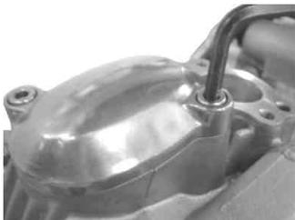
クランクケースカバー部の各プラグボルトのOリングに少量のエンジンオイルを塗布し、各プラグボルトを取り付け、規定トルクで締め付けます。
