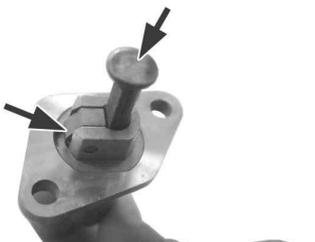
新品のガスケットとカムチェーンテンショナーをシリンダーにワッシャ、ボルトで取り付け締め付けます。カムチェーンテンショナー部のOリングが付いていることを確認し、スプリングとキャップボルトを取り付け、規定トルクで締め付けます。
