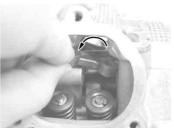
ストッパープレートをキット付属 のソケットキャップスクリュー6 ×10を使用して取り付ける。 ノックピン5×8を取り付ける。
