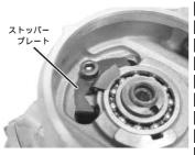
吸・排気側のロッカーアームシャ フトを、スライディングハンマー を使用して取り外し、ロッカー アームを取り外す。
