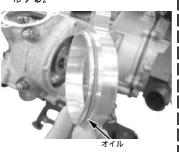
スプロケットカバーのOリングに | オイルを塗布しキット付属のフラ | ンジボルト(6×35)取り付ける。|
