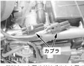
・燃料タンク取り付けボルトを取り 外しタンク後部を持ち上げる。
