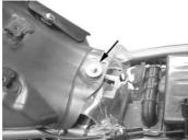
燃料ホースジョイントの隙間にマ イナスドライバーを挿し込みドラ イバーを回してジョイントロック を外す。
