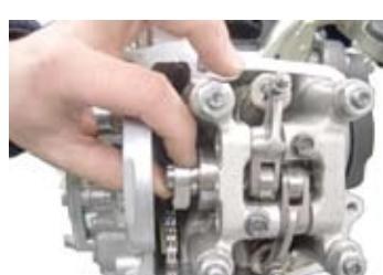
◇カムシャフトを下の写真の位置まで抜いたらカムシャフトを180°回転させ抜き取る。
