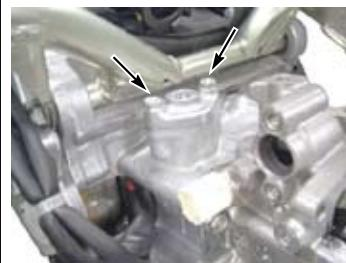
◇細いマイナスドライバーを使用しアジャスターを反時計方向に回しカムチェーンテンショナーリフターを戻す。
