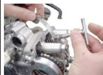
◇タベットアジャストスクリューロックナットのねじ部と座面にエンジンオイルを塗布する。
