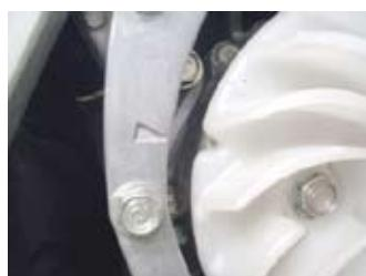
◇カムスプロケットの合わせマークがシリンダーヘッド端面に合っていて“KWN”マークがエンジン上側にある事を確認する。
