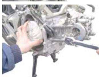
◇タペットアジャストロックナットを緩め、タペットアジャストスクリューを一杯まで緩める。
