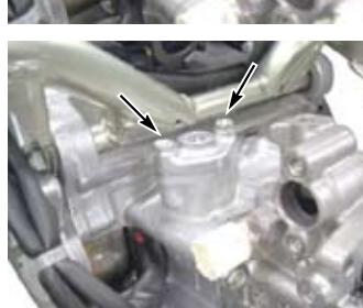
◇クーリングファンを押さえ、カムスプロケット取り付けボルトを取り外す。
