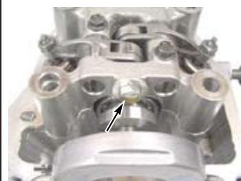
◇クーリングファンを時計方向に回し、クーリングファンの“T”マークとラジエーターベースの合わせマークを合わせる。
