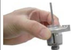
◇その状態でテンショナーを取り付け、ボルト2本を規定トルクで締め付ける。
