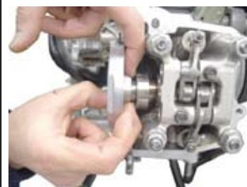
◇カムシャフトストップーボルトを規定トルクで締め付ける。
