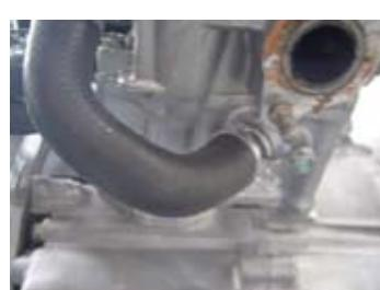
◇純正サービスマニュアルを参照し冷却水の注入、エア抜き、エンジンを取り付ける。
