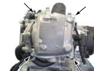
◇クーリングファンを時計方向に回し、クーリングファンの“T”マークとラジエータベースの合わせマークを合わせる。
