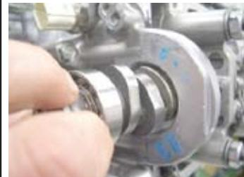
◇カムシャフトを下の写真の位置まで挿入したらカムシャフトを180°回転させ取り付ける。
