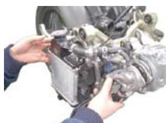
◇ボルト3本を締め付けウォーターポンプカバーボルトを締め付ける。
