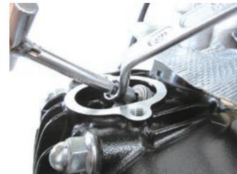
◇クランクシャフトを反時計方向に2回転まわし、再度カムプロケットとフライホイールの合わせマークを合わせバルブクリアランスが変化していないか確認する。
