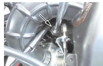
◇コネクティングチューブとスロットルボディを接続し、バンドのクランプを締め付ける。
