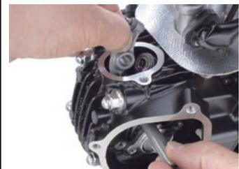
◇ロッカーアームシャフトストッパをネジロック剤を塗布したスクリーン2本にて取り付ける。
