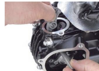
◇カムシャフトを抜き取る。※エンジン組立て時や使用に伴い、シリンダーヘッドはわずかに歪み、カムシャフトが非常に脱着しにくい場合があるので、その際はシリンダーヘッドを取り外し、脱着を行う。
