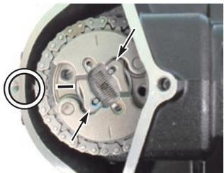
◇カムプロケットの穴にカムシャフトのネジ穴を合わせ、ネジロック剤を塗布したソケットキャップスクリュー2本を取り付ける。
