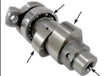
◇付属のカムシャフトをシリンダーヘッドに取り付ける。この時、シリンダーヘッドの切り欠き部にカムシャフトのカム山を合わせながら差し込んでいく。※シリンダーヘッドの個体差により、シリンダーヘッドの切り欠き部とカム山が干渉する場合があるので、その際はシリンダーヘッドの修正加工を行う。※修正加工の際はエンジン内に削り粉が入らないようにしっかりとウエスを詰めて、ヤスリ、リウター等を用いて少しずつ削り、削り粉がエンジン内に入らないように慎重にウエスを取り除く。削りすぎないように注意する事。
