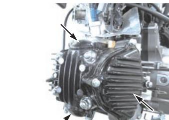
◇フライホイールを保持し、カムスプロケットのボルト2本を取り外す。◇カムスプロケットを取り外す。◇スロットルセンサコネクタの接続を外して、シリンダーのカムチェーンテンショナーのボルトを取り外し、ストッパーを時計方向にいっぱいまで回し、プッシュロッドをロックさせる。
