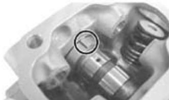
◇シリンダーヘッドにキット内のストッパープレートのストッパー部をシリンダーヘッド右側に向け、ロッカーアームと共にセットします。
