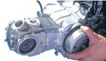
◇タペットすき間が変化していないか点検しすき間が合っていればOK、くるっている場合は再度調整する。
