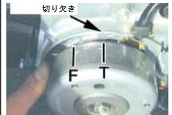
◇カムプロケットボルト穴をシリンダーヘッドの切り欠き方向に向けたときカム山がピストン側を向く様にかむシャフトをセットする。
