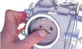
◇フライホイールを固定してカムスプロケットボルトを2本締め付ける。
