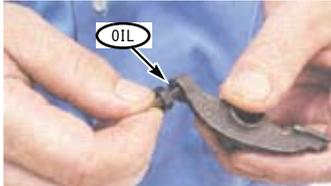
◇専用のカムシャフトの両端のベアリングにエンジンオイルを塗布します。
