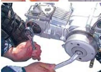
◇キット内の右サイドカバーガスケットをキット内の右サイドカバーにセットし、シリンダーヘッドにキット内のフランジボルト2本を用いて取り付け、規定トルクまで締め付けます。
