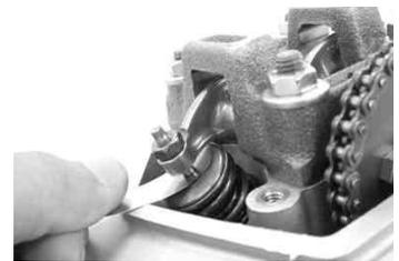
引き抜くときに少し抵抗があるぐらいにアジャストスクリューを合わせ、ナットを締め付けます。
