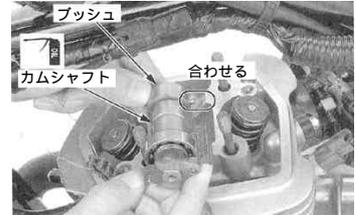
ノックピン2個を取り付け、写真の様にカムチェーンの中にカムシャフトをくぐらせておきます。
