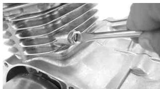
マイナスドライバーでアジャストボルトを固定し、ロックナットを締め付けます。
