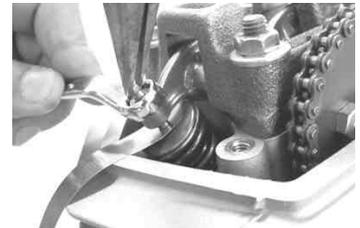
ナットを締め付け後、0.1mmのシクネスゲージを再度差し込み、バルブ隙間を確認します。
