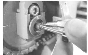
カムシャフトチェーンテンショナーのキャップボルト、スプリングを外し、プッシュロッドが飛び出していないか確認します。
