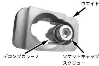
デコンプガイド、ウエイト、デコンプカラー2の順に取り付け図を参考に規定トルクで締め付けます。
