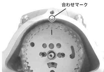
デコンプガイドをネジ取り付け部の板厚が厚い方を上(IN側)に、薄い方を下(EX側)にし、キャップスクリュー6×12を下(EX側)に取り付け、規定トルクで締め付けます。
