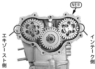
ノック穴に対するCAM TOP クランク角度 (ATDC)
