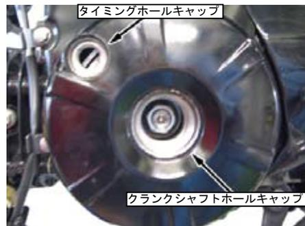
◇フライホイールの T マークが L. クランクケースカバーの印と合うまで、クランクシャフトを反時計方向に回しピストンが圧縮上死点にある事を確認する。
