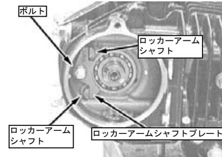
◇カムシャフトの溝部を図の様に上向きにして、シリンダーヘッドから外す。
