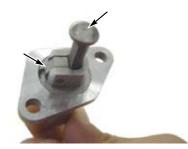
◇新品のガスケットとカムチェーンテンショナーをボルト2本でシリンダーに取り付ける。 0リング、スプリング、キャップボルトを取り付ける。
