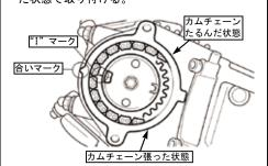
◇カムシャフトの切り欠きをカムスプロケット の爪に合わせて取り付け、ブリーザープレー トとカムスプロケットボルトを取り付ける。 フライホイールを保持し、カムスプロケット ボルトを締め付ける。
