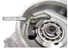
◇吸・排気側のロッカーアームシャフトを、 スライディングハンマーを使用して取り外し、 ロッカーアームを取り外す。
