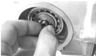
カムシャフトにロックピンを取り付ける。
