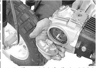
シリンダーヘッド左カバーガasketと左カバーを取り付ける。(左サイドカバーがボルトを締めたときに回りしないように回り止めを合わせる)
