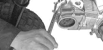
タペットキャップ2個を取り付ける。 締め付けトルク 12 N・m (1.2 kgf・m)
