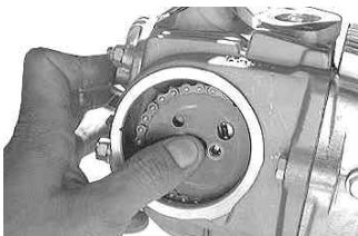
カムスプロケットのOマークとシリンダーヘッドの切りかき部が合う様にカムチェーンをはめてカムシャフトに取り付ける。カムスプロケットをはめたあとはボルトを取り付ける。
