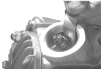
シリンダーヘッド右側の六角ボルト(矢印)を締める。
