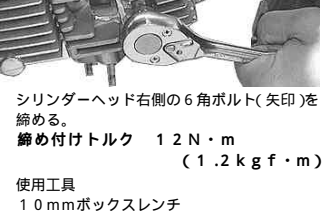
シリンダーヘッド右側の六角ボルト(矢印)を締める。
