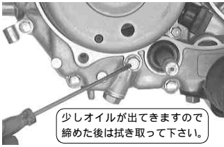
チェンジベダルのシャフトの横にある六角ボルトを取り外す。カムチェーンを引っ張っているテンションナーがゆるむのはためやすくなる。
