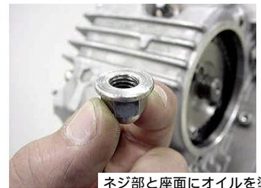
f. シーリングワッシャ4個を取り付けます。シリンダーヘッドカバーナット4個のねじ部と座面にエンジンオイルを塗布し、仮止めします。シリンダーヘッドカバーボルト4本を仮止めします。
