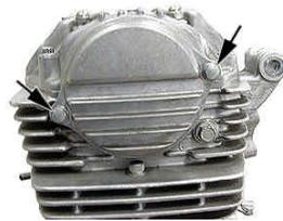
b. カムスプロケットカバーのボルト2本を外し、カムスプロケットカバーとガスケットを取り外します。
