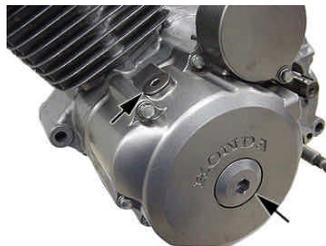
a. タペットホールキャップ2個、クランクシャフトホールキャップ、タイミングホールキャップを取り外します。
