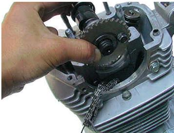
g. カムプロケットからカムチェーンを外して、取り外します。カムチェーンをクランクケース内に落とさないように注意して下さい。カムチェーンは針金等で吊って下さい。
