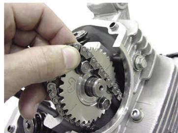
c. クランクシャフトのタイミングプロケットにカムチェーンがはまっていることを確認し、カムプロケットにカムチェーンを取り付けます。
