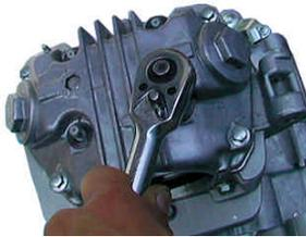
f. シリンダーヘッドカバーのボルトとナットを対角に2～3回に分けてゆるめて取り外し、シーリングワッシャとシリンダーヘッドカバーを取り外します。
