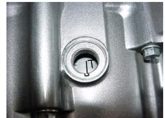
c. クランクシャフトを反時計方向に回し、フライホイールの“T”マークをクランクケースカバーの合わせマークに合わせて、圧縮上死点であることを確認します。（ロッカーアームを手で動かし、ガタのある状態）
