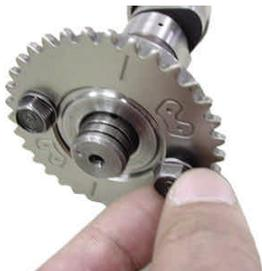
h. ゆるめておいたカムプロケットボルト2本を取り外します。カムプロケットを付属のカムシャフトに取り付けてカムプロケットボルト2本を仮止めします。
