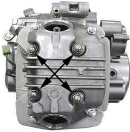
先にシリンダーヘッドカバーナットを、後にシリンダーヘッドカバーボルトを締め付けます。共に対角に2～3回に分けて締め付けて下さい。
