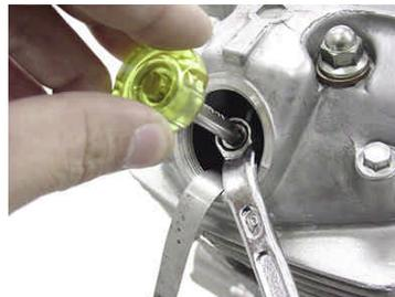
クリアランスの調整が必要な場合は、ナットをゆるめアジャストスクリューを締め込んでいきます。アジャストスクリューを固定し、ナットを締め付けます。
