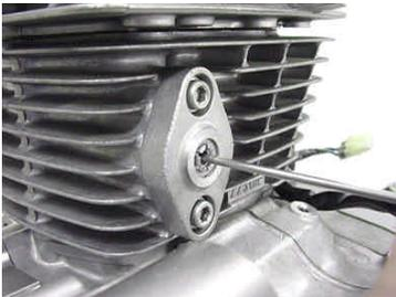
h. カムチェーンテンションのストッパーを反時計方向に回し、ロックを解除します。
