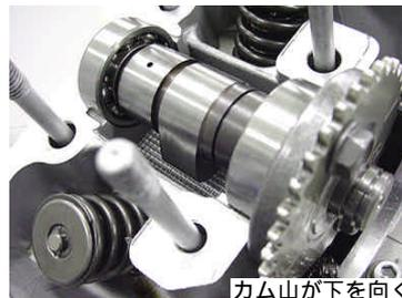
b. ベアリングにきれいなエンジンオイルを塗布し、カムプロケットの刻印線がシリンダーヘッドカバー合わせ面と平行かつカム山が燃焼室側になるように取り付けて下さい。
