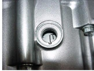
a. フライホイールの“T”マークがクランクケースカバーの合わせマークに合っているか確認します。
