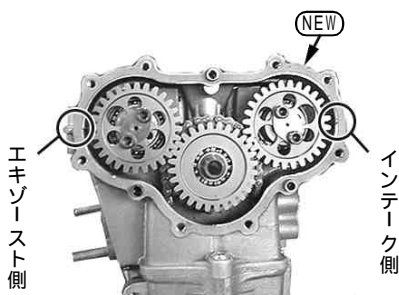
ノック穴に対するCAM TOP クランク角度(BTDC)
