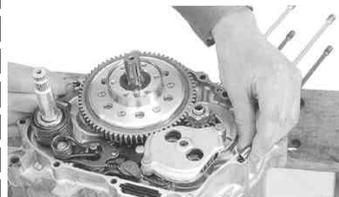
キット内の部品のR.クランクケースガスケットを取り付け、オイルスルーを取り付けます。
