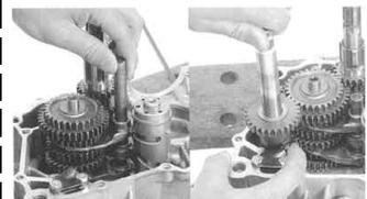
キット内のクランクシャフトのベアリング部に、エンジンオイルを塗布します。
