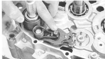
シフトドラムストッパープレート及びシフトドラムストッパーを取り付け、規定トルクで締め付けます。
