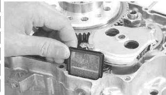
スクリーンは必ず洗浄して取り付けして下さい。ゴミ等が付着してオイルを通さない場合、最悪の場合エンジンが焼き付く可能性があります。
