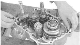
クランクケース合わせ面をきれいに脱脂し、キット内の新品のクランクケースガスケットを取り付け、ケース内の可動部にエンジンオイルを塗布します。
