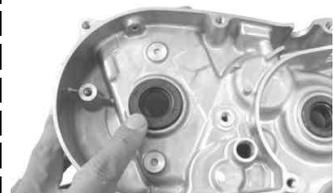
クランクケースのベアリング部にエンジンオイルを塗布します。ケースボーリング時に取り外した部を取り付けます。ガイドプレート、リターンスプリングピンボルトを取り付けます。
