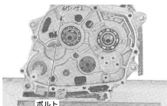
専用工具を使用してフライホイールを取り外します。
