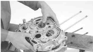
フランジボルト2本のネジ部に少量のアルミスベシャルを塗布し、取り付け締め付けます。
