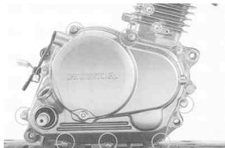
サービスマニュアルを参照し、クラッチ、シフトドラムストッパー、シフトドラムストッパープレート、プライマリードライブギヤ、オイルポンプを取り外します。
