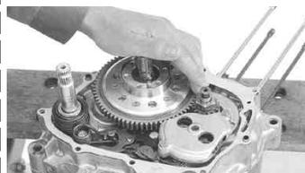
クラッチカバーオイルシールリップ部にグリースを少量塗布し、クラッチケースカバーを取り付け、ケース外周のボルトのネジ部に少量のアルミスベシャルを塗布し、規定トルクまで締め付けます。
