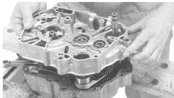
クランクケースボルトのネジ部に少量のアルミスペシャルを塗布し、クランクケースにボルトをセットし、対角線上に規定トルクまで締付けます。
