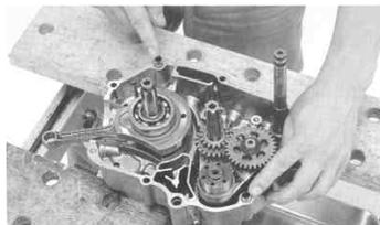
クランクケースにキット内のガスケットをセットし、右クランクケースを取り付けます。
