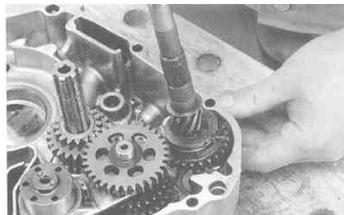
キットのクランクシャフトの大端部及びベアリング部にエンジンオイルを差します。
