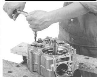
ギアシフトドラムワッシャの向きに注意し、六角ボルトを用いて規定トルクまで締め付け、ラバープラグを取り付けます。
