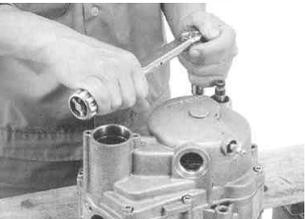
スタットボルトネジ部に少量のアルミスペシャルを塗布し、クランクケースにスタットボルトを取り付け、規定トルクで締め付けます。
