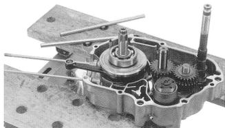
オイルポンプを取り外します。キックスタータースピンドルを外し、トランスミッション、ギアシフトドラムを一体で取り外します。
