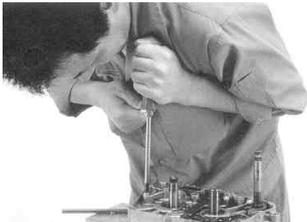
使用するクラッチキットの取り付け要領を守り、クラッチを組み付けます。
