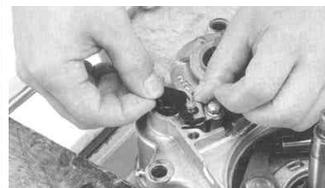
クランクケースガスケットのホール部分と、シリンダー合わせ面をカッター等で切り落とし、フラットに仕上げます。クランクケース内にガスケットくずが入らない様、注意する事。
