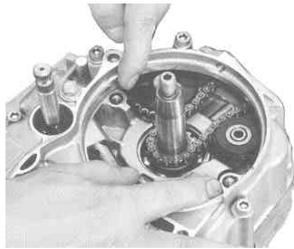
ジェネレータープレートを取り付け、フラットスクリューを締め付けます。
