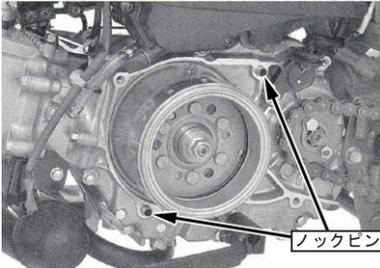
○L. クランクケースカバーのスクリュー4本を取り付け締め付けます。
