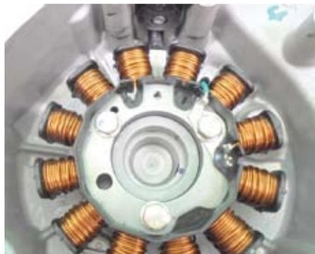
○の③ボールベアリングをステータコイル中央部に取り付け、④ベアリングホルドプレートを方向に注意してセットする。
