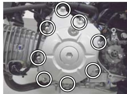
○ノックピン2本を外し、クランクケースやL. クランクケースカバーの取り付け面に残ったガスケットをきれいに取り除く。
