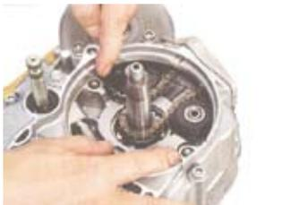
○ジェネレータープレートを取り付け、フラットスクリューを締め付けます。
