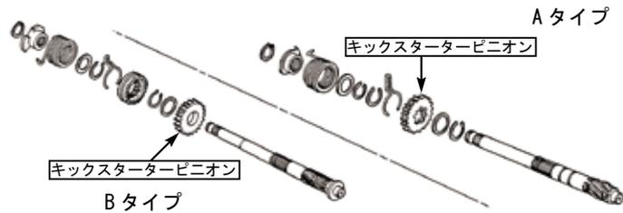
5速ミッションキット取り付け際はキックスタータースピンドルが左に記す様にAタイプの場合は必ずBタイプに交換して下さい。
