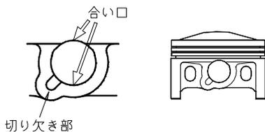
ピストンのリング溝にエンジンオイルを塗布し、図を参考にしてピストンリングを取付け、合い口を合せます。
