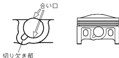
ピストンのリング溝にエンジンオイルを塗布し、図を参考にしてピストンリングを取り付け、合い口を合せます。
