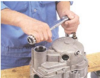
○スタッドボルトに少量のアルミスペシャルを塗布し、クランクケースに取り付け、規定トルクで締め付けます。短い方のスタッドボルト A 6x194.5 を R. クランクケース（クラッチ側）に取り付けます。
