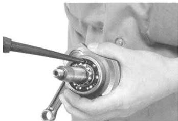
クランクケースにキット内のガスケット、ロックピンをセットし、右クランクケースを取り付けます。
