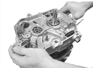
クランクケースボルトのネジ部に少量のアルミスPECIALを塗布し、クランクケースにボルトをセットし、対角線上に規定トルクまで締め付けます。
