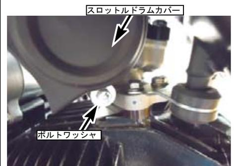
・仮止めしていたエアクリーナーのボルト2本を規定トルクにて締め付ける。
