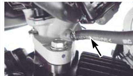
・ボルトワッシャを取り外し、スロットルドラムカバーを取り外す。
