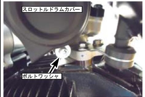
・インレットパイプのボルト2本を取り外し、インシュレーターを取り出す。インシュレーター両面のOリング2個の紛失に注意する事。
