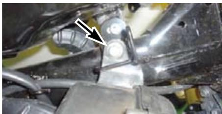
・インレットパイプ/スロットルボディ/エアクリーナーケースがつながれたままで取り外しながらフレームのガイドからフューエルホースを取り外す。エンジン、フレーム間から抜き取り、フューエルホースに負担が掛からないようにフレーム等に置いておく。
