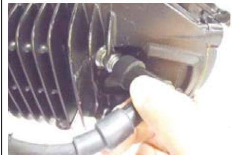
・ボルトを取り外し、シリンダーの油温センサーガードを外す。
