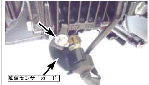
・油温センサーのカプラーの接続を外す。油温センサー及びシーリングワッシャを取り外す。
