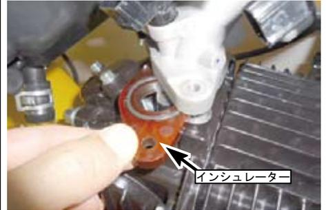
・エアクリーナーケースの吸気温センサーのカプラの接続を外し、コネクティングチューブのクランプから配線を外す (GROM の場合)。
