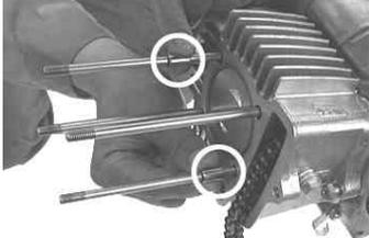
シリンダーにノックピン2個を取り付ける。
