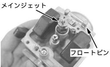
4本のスクリーを外してフロートチャンバーを取り外します。
