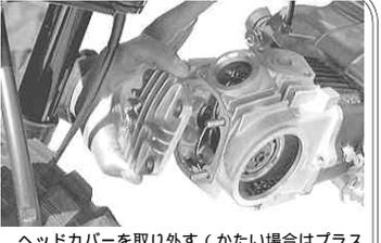
ヘッドカバーを取り外す。(かたい場合はプラスチックハンマーで軽くたたき、取り外す)シリンダーヘッドにガスケットが残った場合は、スクレーパーかカッター等できれいに取り除く。
