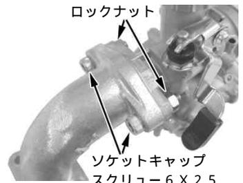
キャブレターとインレットパイプをソケットキャップスクリー6X25/ロックナット2セットで取り付ける。
