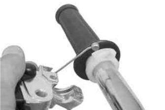
スロットルパイプからスロットルケーブルのインナーケーブルを外す。
