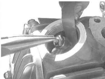
ロッカーアームのタベットスクリューを締め込んでいきタベットスクリューとバルブステムエンドの間に0.05ミリのシックネスゲージを入れて少し抵抗があるくらいで引き抜ける様に合わせてタベットナットを締め付ける(少し抵抗があるというのわからない場合0.07と0.03のシックネスゲージを用意して0.07がすぎ間に入らず0.03がゆるく入る様に合わせればだいたい0.05ミリということになる)IN・E・X共に0.05ミリに合わせる。
