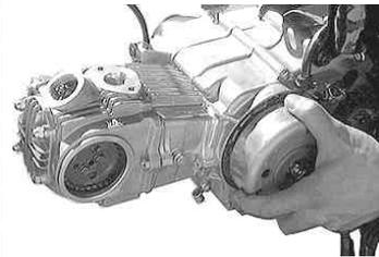
タベット調整後、反時計方向にフライホイールを2回転手で回した後でTマークとOマークを合わせる。
