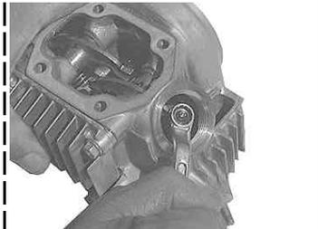
シリンダーヘッドに組まれているロッカーアームのタベットナットとボルトを取り外す。タベットナットを緩めた時点でタベットボルトをナットと一緒に取り外す。
