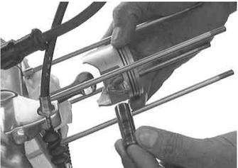
ピストンに三分の一程度ピストンピンを挿入しておいて取り付けるのも簡単な方法ではある。付属のピストンピンサークリップをサークリップ溝にきっちりとはめ込む。
