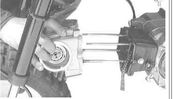
フロントタイヤを押しながらシリンダーヘッドを取り外す。ここでタイヤの空気を抜いた訳をご理解いただきたいと思います。ノックピン2個は再使用するので取り外しておく。
