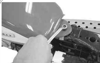
フューエルタンクをフレームにボルトで取り付ける。
