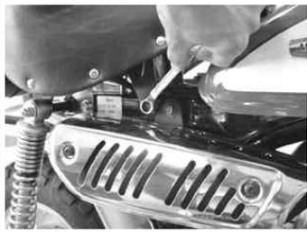
シート下にボルトを差し込み、ナットを取り付ける。
