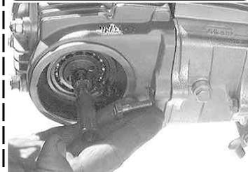
ヘッドサイドボルトを取り付ける。先に仮止めし
