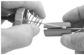
キャブレターのトップキャップを外し、スプリングとスロットルバルブを取り外す。
