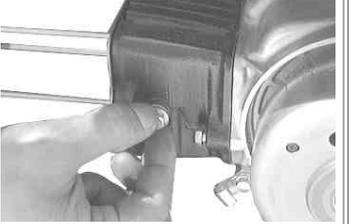
緩めておいたガイドローラーボルトとシリンダーサイドボルトを反時計方向に回し取り外す。
