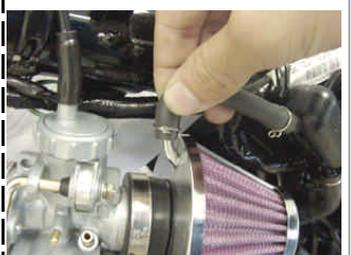
ストレージタンクのホースをエアフィルターに取り付ける。(フレームNO. AB27の車両の場合)
