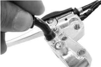
キット内のスロットルケーブルをロアスロットルハウジングに取り付ける。
