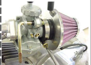
バンドをエアフィルターに付け、キャブレターに差し込む。バンドを締め付ける。
