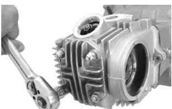
シリンダーヘッドカバーを止めているナット4個を対角の順番に反時計方向へ回し取り外す。
