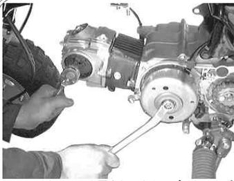
フライホイールを固定してカムスプロケットボルトを2本締め付ける。
