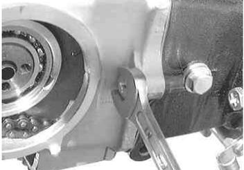
シリンダーヘッドとシリンダーを止めているシリンダーヘッドサイドボルトを反時計方向に回し取り外す。
