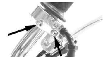
アッパースロットルハウジングを2本のスクリーで取り付ける。
