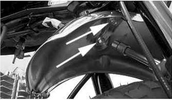
フロントフェンダー裏側の六角ボルト2本を締めて取り付ける。
