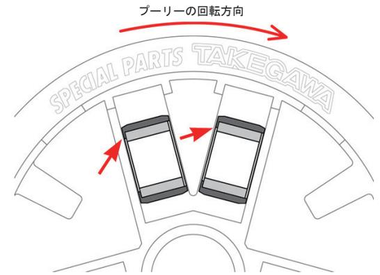
▲注意：逆向きに取り付けた場合、ウエイトローラーが磨耗してくると、ウエイトローラーのインナーとプーリーが接触し、プーリー内のウエイトローラー摺動面に傷を付け、変速不調及びプーリー損傷の原因となる恐れがあります。
