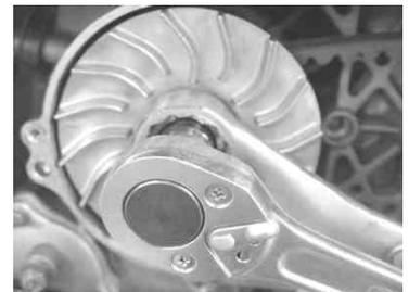
5. ガasket、クラッチカバー等取り外した部品を元通りに取り付けます。換気の良く、安全な場所でエンジンを始動し、異常が無いか確認します。
