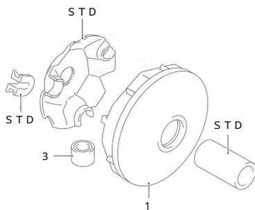
ウェイトローラーは、当社製ボアアップと当社製マフラー(サイレントボンバー)を取り付けた状態に適しております。エンジン仕様や、条件に合わせたセッティングを行って下さい。
