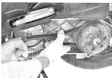
4. プーリーフェイス、Vベルト、フィクストドリブンフェイスを組み付けます。
